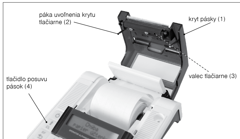
Obrázok 2.6 – Zavedenie papierovej termo pásky do tlačiarne pokladnice
