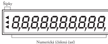
Obrázok 2.7 – Rozdelenie 7-segmentového LCD displeja
